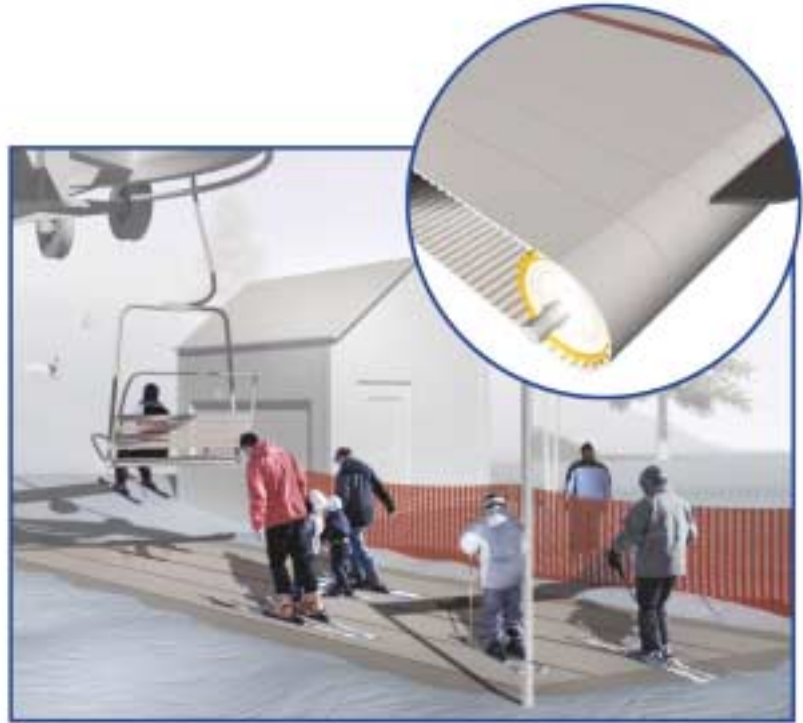
폭 45cm의 타이밍 벨트 4개가 스키어들을 가속시켜 체어 리프트에 더 신속하게 탑승할 수 있도록 합니다. 타이밍 벨트는 각 스키어들이 일정한 속도를 유지할 수 있도록 합니다.
