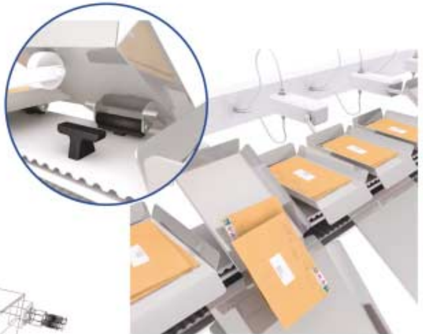
주문 제작 프로파일이 틸트 트레이(tilt tray) 방식의 우편물 분류기에서 편과 받침으로 사용되고 있습니다.
